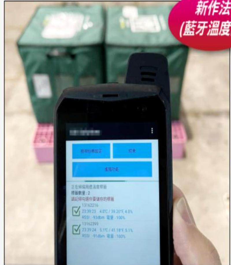
配送物流車上的疫苗溫度監測方式，傳統作法是在保冷箱內放入溫度監視片或冰球，以目視辨識來檢視監視片有無變色或冰球破裂，對於疫苗溫度監控不夠即時，新作法則是多裝入一支IoT藍牙溫度計，靠IoT即時訊號傳輸，不僅能提供全程配送的溫度監控與追蹤，而且更即時，可提供每3分鐘更新頻率。(圖片來源 / 裕利醫藥)
