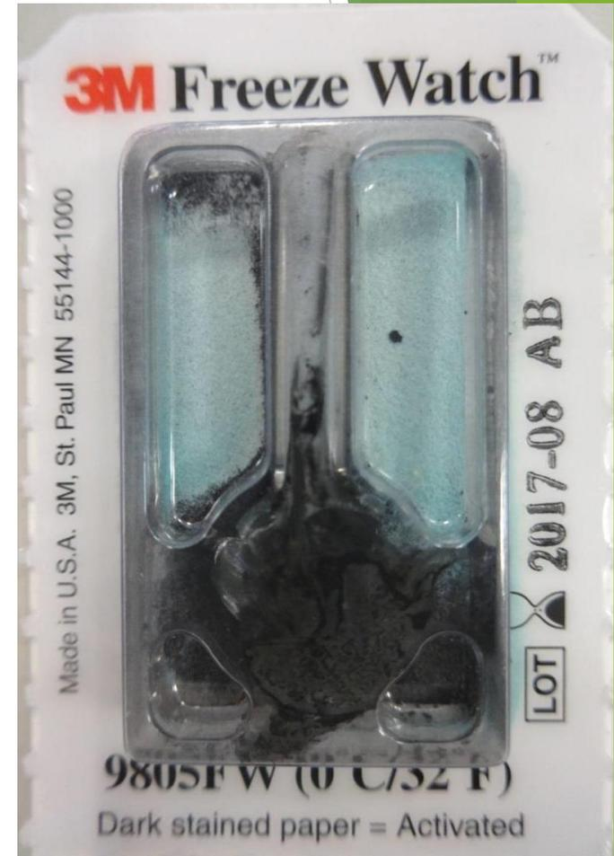
小球破裂、紙被染變色表示曾暴露於0°C以下
